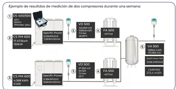
Esta es una posible combinación de equipos para medir la eficiencia energética de forma eficiente
