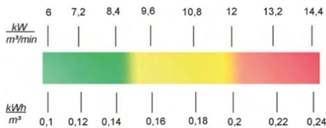
La potencia específica en [kWh / m³] o [kW / l m³/min] corresponde a la eficiencia del sistema de aire comprimido. Un sistema ineficiente requiere más energía para generar una cierta cantidad de aire comprimido y, por lo tanto, hace que los procesos de producción sean más costosos. Desafortunadamente, esto no se puede deducir de la hoja de datos del compresor porque solo indica la potencia mecánica del eje y no la potencia eléctrica real consumida.
